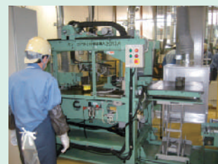
カットコア鉄心解体作業
