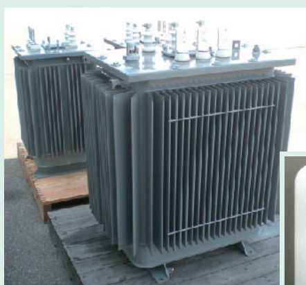
トッランナー変圧器
