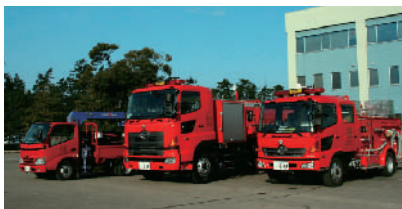
(左から) 泡消火剤運搬車、水タンク車、化学消防車
