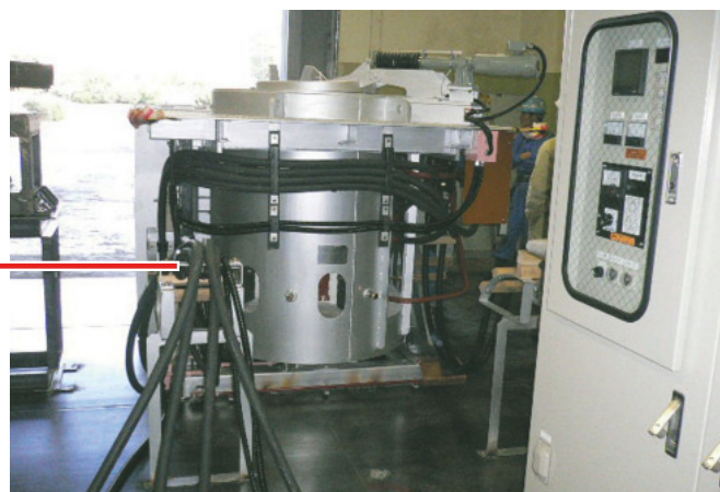
150kW誘導溶融加熱炉
