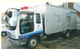
電源車【電源車の仕様】300kVA×5台
