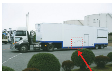
誘導溶融加熱炉等を搭載したトレーラー(オンサイト式アスベスト溶融・無害化処理システム)
