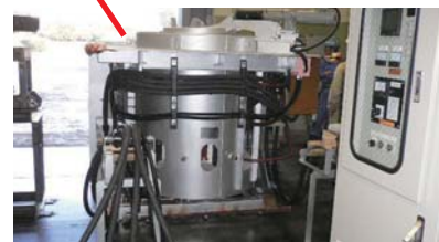
150kW誘導加熱溶融炉
