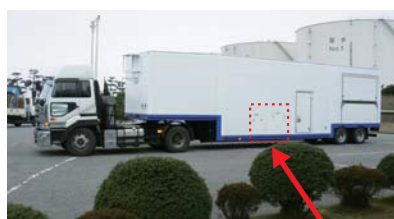
誘導加熱溶融炉等を搭載したトレーラー(オンサイト式アスベスト溶融・無害化処理システム)
