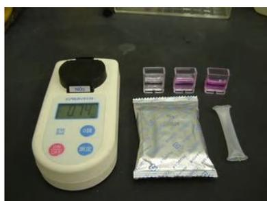
第8図 水質分析試薬と水質計による測定
