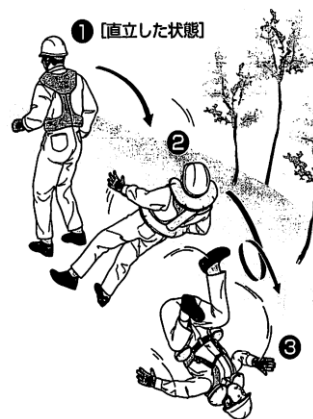
第6図 転倒・滑落用保護具が開く事例2
