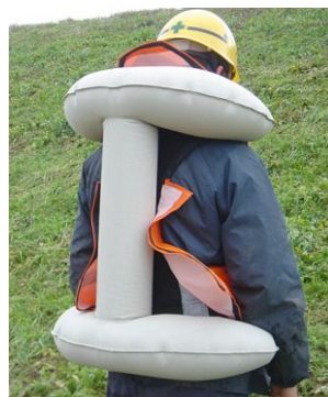
第8図 転倒・滑落用保護具が開いた状態
