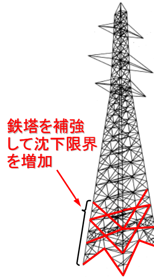
第6図 部材補強部位
