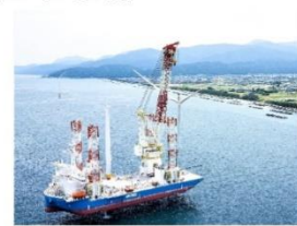
自己昇降式作業台船（SEP船）による海上施工の様子
