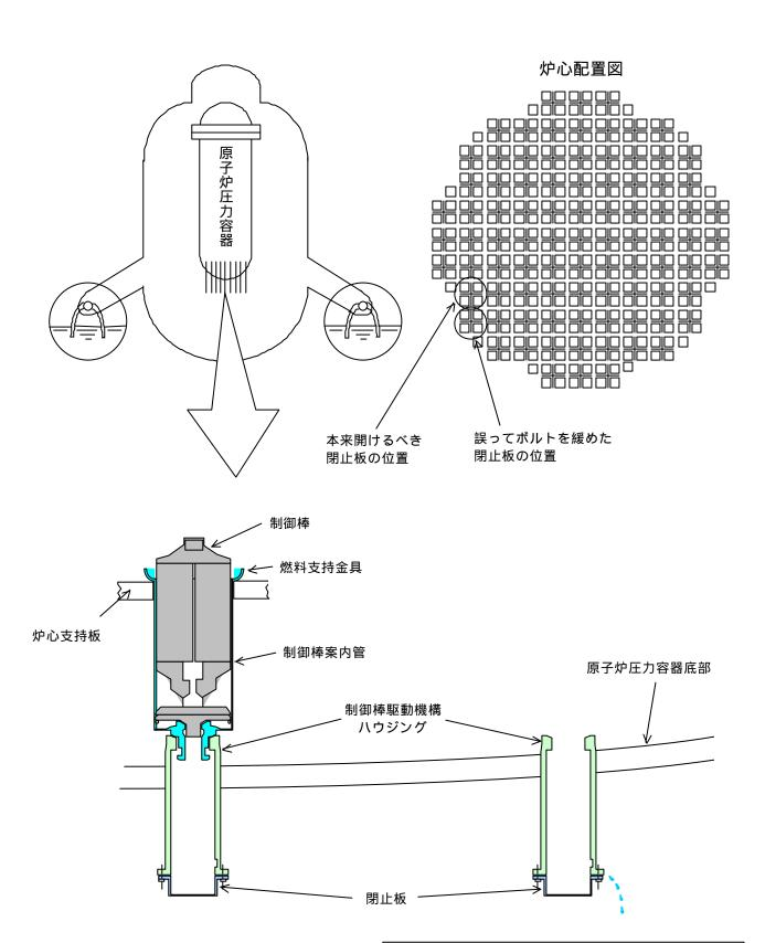
左図の閉止板を開けるべきところ、隣の閉止板の ボルトを緩めたため、水がこぼれた。
