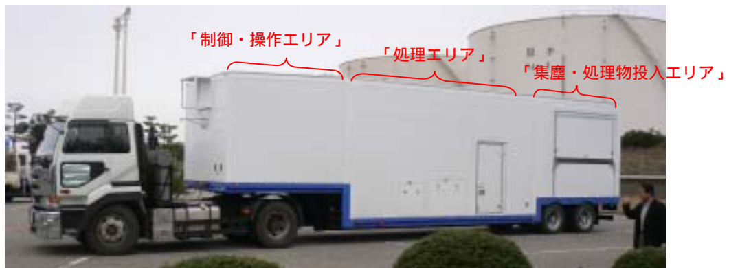
図2 オンサイト式アスベスト溶融・無害化処理システム
