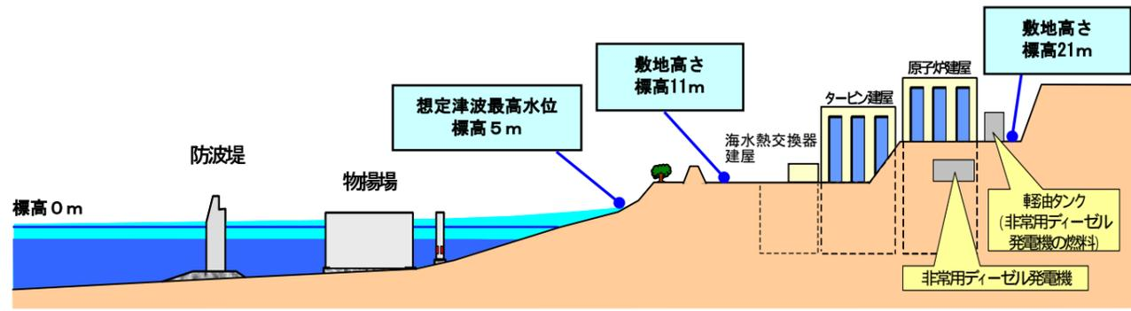
想定津波最高水位（標高 5 m）に対して敷地高さは 11m 以上であり、津波に対して基本的に安全性は確保されている。
