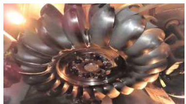
栃尾発電所ランナ（水車羽根車）
