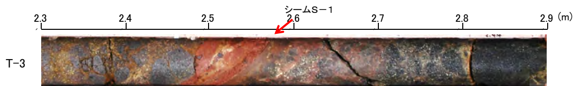
コア写真(シームS-1付近拡大)
