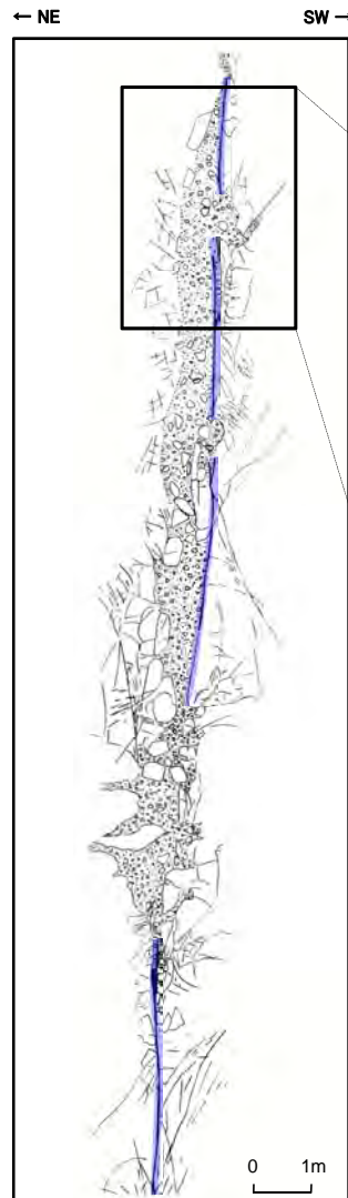
原子炉建屋底盤(EL-7.1m)に認められる シームS-1の詳細スケッチ
