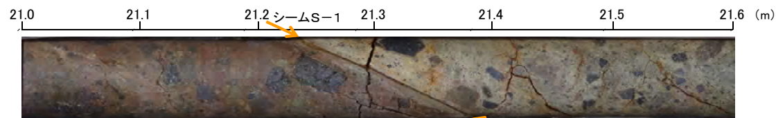
コア写真(シームS-1付近拡大)
