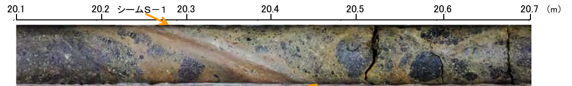
コア写真(シームS-1付近拡大)
