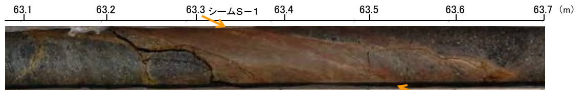
コア写真(シームS-1付近拡大)
